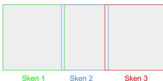
Příklad nedostatečného překrytí
